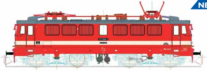
31610 Ellok der Baureihe 211 der DR 6 Einzellüfter, rot, mit grauem Dach, Epoche IV
