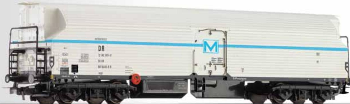
Maschinenkühlwagen der INTERFRIGO, eingestellt bei der DR
