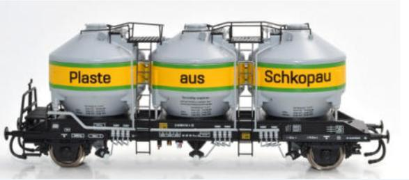
**2-achsiges Silowagen-Set Bauart Uc-y der DR Plaste aus Schkopau**
