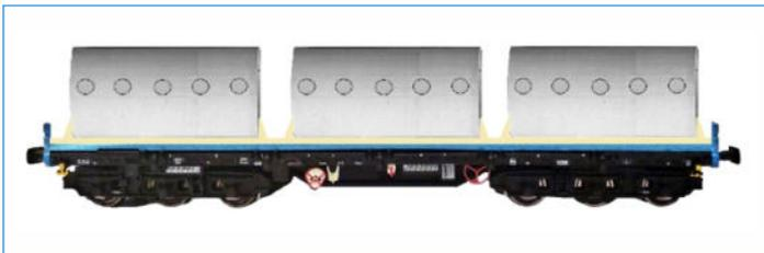
**6-achsiger Schwerlastwagen Bauart Salmms 454 Stahlwerke Siegen**
