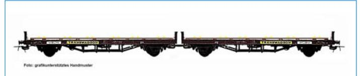
4achsige Flachwagen-Doppel einheit Bauart Laas 1 der Fa. Transwaggon eingestellt bei der DB AG (Epoche V) rotbraun einfarbig, unbeladen, mit Halter für Radfahrzeuge
