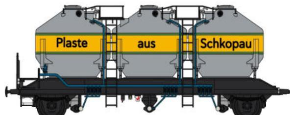
**2-achsiger Silowagen-Set Bauart Uc-y der DR Plaste aus Schkopau** (Epoche IV) zum Transport von Kunststoffgranulaten
