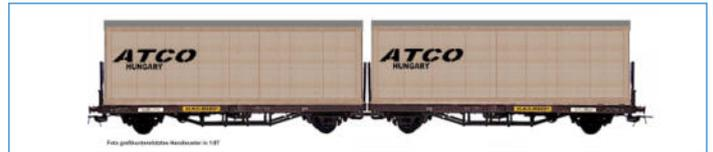
4achsige Flachwagen-Doppel­einheit Bauart Laas 1 der Fa. Railship
