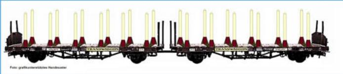
4achsige Flachwagen-Doppel einheit Bauart Laas 1 der Fa. Transwaggon eingestellt bei der DB AG (Epoche V) rotbraun einfarbig, unbeladen, ExTe-Rungen
