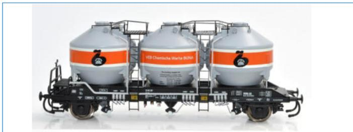
**2-achsiger Silowagen Bauart Uc-y der DR VEB Chemische Werke BUNA**
