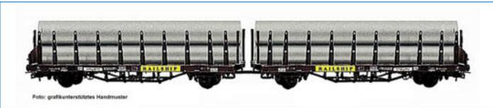
4achsige Flachwagen-Doppel­einheit Bauart Laas 1 der Fa. Railship
