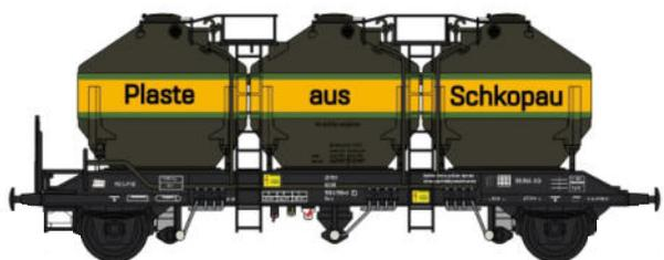
**2-achsiger Silowagen Bauart Uc-y der DR -Nachwendezeit- Plaste aus Schkopau BUNA AG** (Epoche VI) zum Transport von Kunststoffgranulaten
