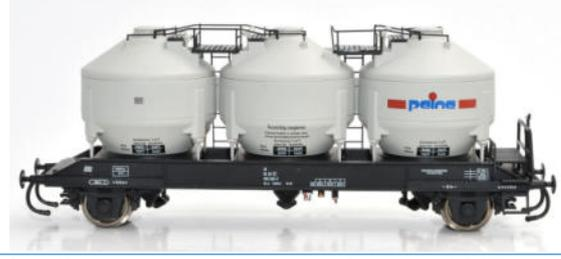
**2-achsiger Silowagen Bauart Uc-y der Peine AG HYDRATKALK**
