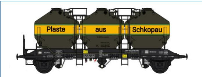
**2-achsiges Silowagen Bauart Uc-y der DR -Nachwendezeit- Plaste aus Schkopau BUNA AG**
