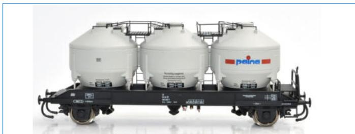
**2-achsiger Silowagen Bauart Uc-y der Peine AG HYDRATKALK**
