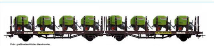
4achsige Flachwagen-Doppel­einheit Bauart Laas 1 der Fa. Transwaggon
