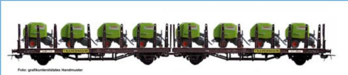
4achsige Flachwagen-Doppel einheit Bauart Laas 1 der Fa. Transwaggon eingestellt bei der DB AG (Epoche V) rotbraun einfarbig, beladen mit Rundballenpresse
