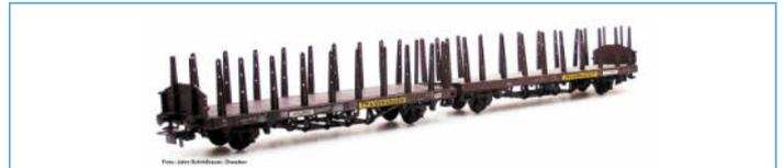
4achsige Flachwagen-Doppel­einheit Bauart Laas 1 der Fa. Transwaggon
