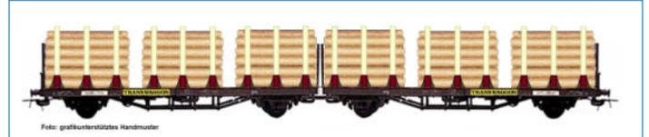
4achsige Flachwagen-Doppel einheit Bauart Laas 1 der Fa. Transwaggon eingestellt bei der DB AG (Epoche V) rotbraun einfarbig, unbeladen, ExTe-Rungen, beladen mit Stammholz
