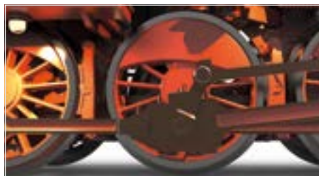
Teilweise durchbrochen dargestellter Barrenrahmen
