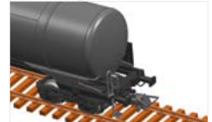
Freistehende Griffstangen und Rangiertritt
