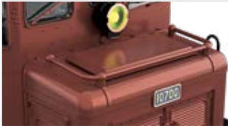
Freistehende Griffstangen und separat angesteckter Deckel am Vorbau
