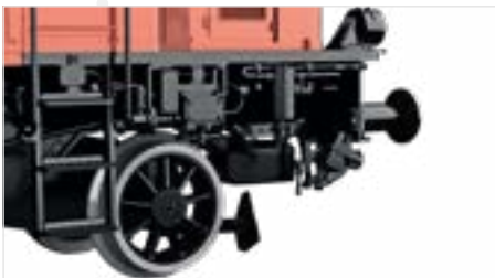
Aggregate und Leitungen freistehend ausgeführt
