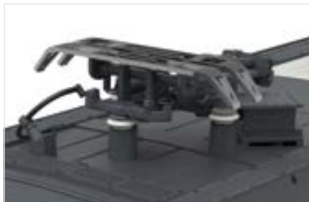
Neu konstruierter Stromabnehmer mit unsichtbarer Befestigung
