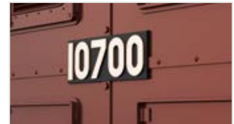
Erhaben ausgeführte Loknummer
