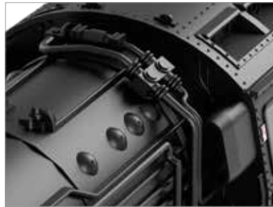
■ Freistehende Leitungen vor dem Führerhaus
