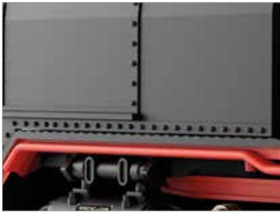
■ Feinste Nieten an den Wagner-Windleitblechen
