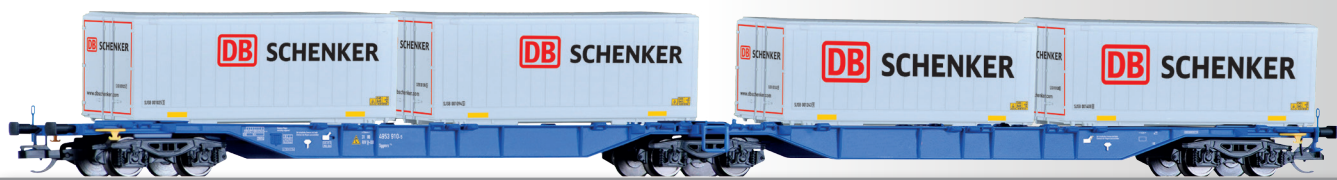
Doppeltragwagen Sggmrs 714 der DB AG, beladen mit vier Wechselbehältern DB Schenker
