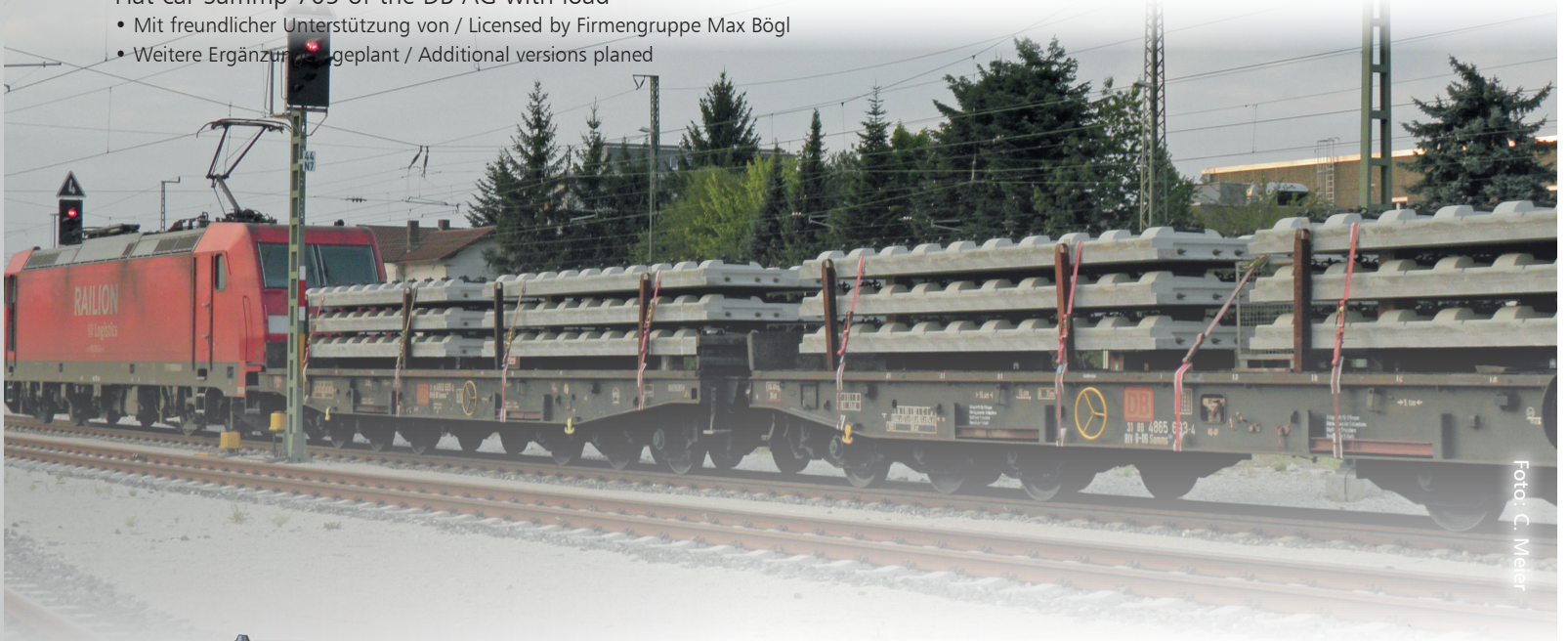
Schwerlastwagen Sammp 705 der DB AG, beladen mit Betonteilen „Feste Fahrbahn Bögl“
