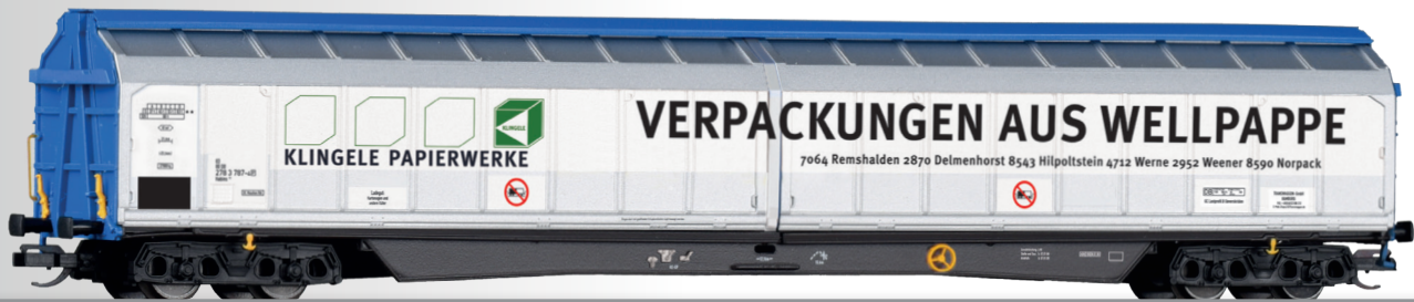
Schiebewandwagen Habins „Klinge Paperwerke“ der DB AG Sliding wall box car Habnis “Klinge Paperwerke” of the DB AG
