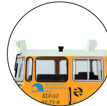
Versión de la carrocería con faros superiores
