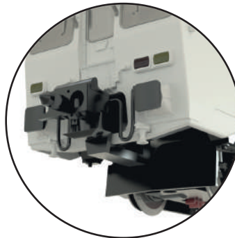
Enganche frontal intercambiable, funcional
