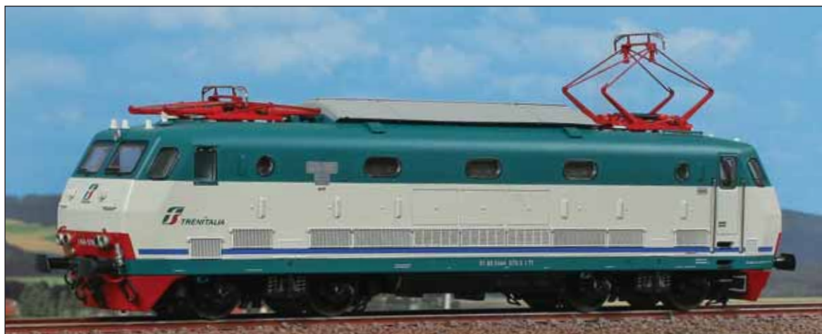
Locomotiva elettrica FS E.444R stato attuale, con conduttori a 13 poli per il comando lateralizzato delle porte del treno. Electric Locomotive FS E.444R in today's conditions, with 13-pin cable for independent side control of the train doors. E-Lok E.444R der FS in derzeitiger Version, mit 13-Pol-Kabel für die seitenabhängige Steuerung der Zugtüren
