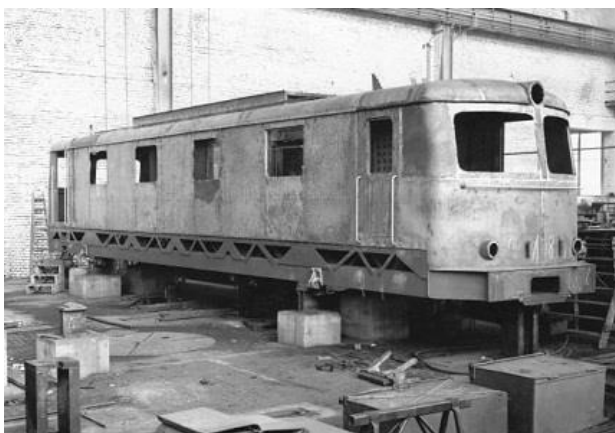
Rozpracovaná hrubá stavba skříňové lokomotivy E 499.1 v jedné z hal výrobního závodu v Plzni. (fotografie foto Škoda, SOA Plzeň)
