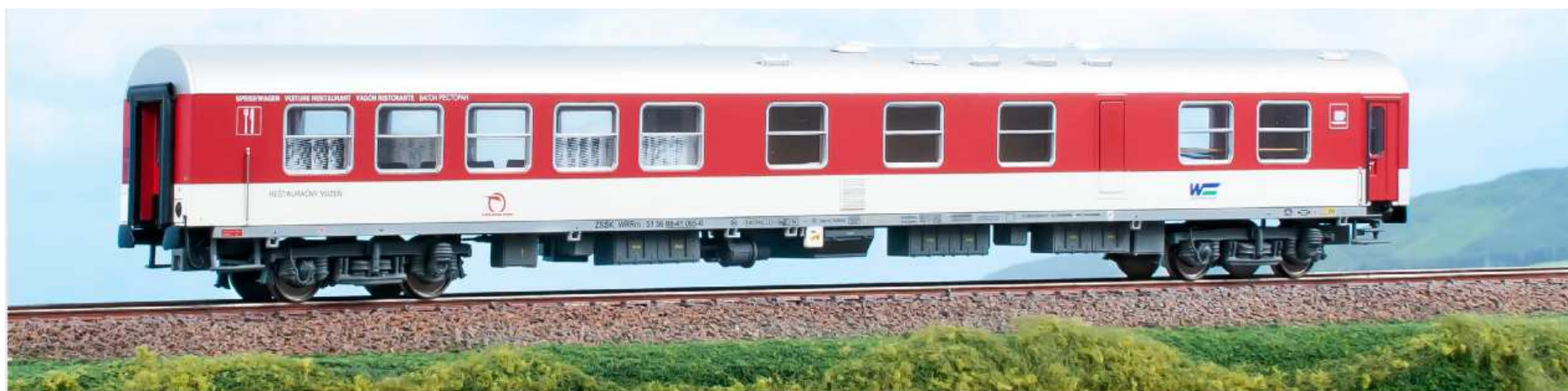
Carrozza ristorante tipo WRRm delle ferrovie slovacche. ŽSSK Slovakian railways restaurant car type WRRm. Speisewagen Typ WRRm der slowakischen Eisenbahnen ŽSSK.
