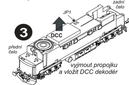
vyjmout propojku a vložít DCC dekodér
