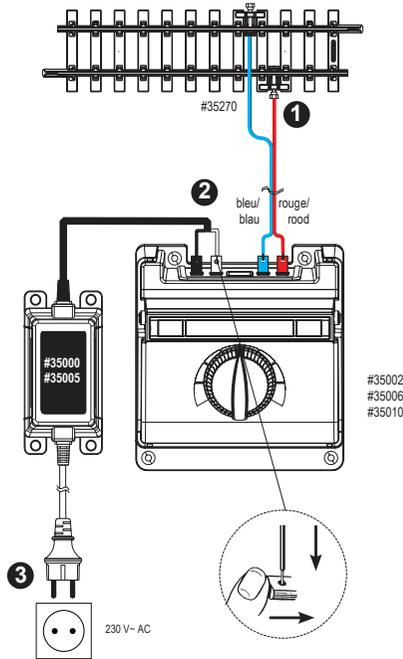
Les transformateurs d'alimentation PIKO #35000 et #35005 servent en première ligne d'alimentation électrique pour les variateurs de vitesse PIKO #35002 et #35006, ainsi que pour la centrale numérique PIKO #35010. Par ailleurs, ils sont une source électrique idéale pour les accessoires sur courant continu comme le pupitre de commande #35260, le boîtier de commande #35261, aiguillages, signaux, éclairages etc. Ils ont été conçus selon les connaissances techniques les plus récentes.
