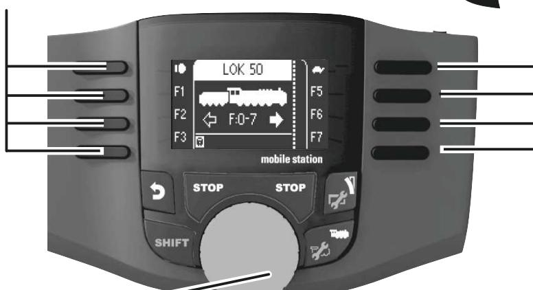
Změna směru jízdy se provádí stiskem knoflíku ovladače.
