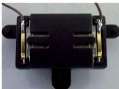
Anschließend sind die beiden Lautsprecherkabel mit den Lautsprecheranschlüssen des Soundmoduls oder den vorgesehenen Löt pads auf der Platine des Fahrzeugs zu verlöten. Der jetzt einbaufertige Lautsprecher kann nun je nach Fahrzeugausführung an geeigneter Stelle im Fahrzeug verschraubt oder verklebt werden.
